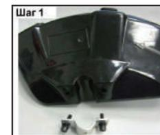
Открутите два винта шестигранным ключом и снимите прижимную скобу.
