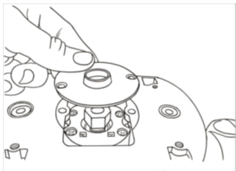
Установка переходной пластины
