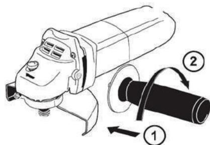
**Установка и снятие защитного кожуха**
