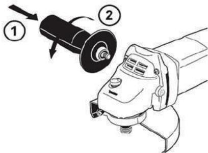
Привинтите боковую рукоятку (5) справа или слева от редукторной головки в зависимости от способа работы.
