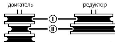
Перестановка ремня из положения I в положения II и обратно производится перемещением ремня вручную в требуемое положение.
