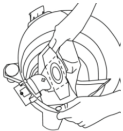
Установка бумажного мешка
