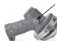
3. Заправляем шприц смазкой, сняв шток полностью - выдавливаем смазку из трубы в цилиндр шприца. Вставляем шток и вносим смазку в отверстие редуктора. Повторяем операцию при необходимости.
