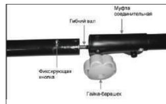
Ослабьте гайку-барашек соединительной муфты, откручивая ее против часовой стрелки. Вставьте четырехгранник гибкого вала в отверстие муфты. Нажмите фиксирующую кнопку на нижней штанге и удерживайте ее в нажатом положении. Соедините верхнюю и нижнюю штанги так, чтобы кнопка на нижней штанге защелкнулась в отверстии на верхней штанге. Затяните гайку-барашек.
