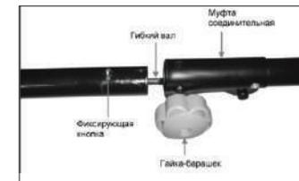
Ослабьте гайку-барашек соединительной муфты, откручивая её против часовой стрелки. Вставьте четырехгранный гибкий вал в отверстие муфты. Нажмите фиксирующую кнопку на нижней штанге и удерживайте ее в нажатом положении. Соедините верхнюю и нижнюю штанги так, чтобы кнопка на нижней штанге защелкнулась в отверстии на верхней штанге. Затяните гайку-барашек.
