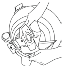
Установка бумажного мешка
