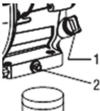
1. Снимите крышку с емкости для масла (1) и отверните спускной винт для слива масла (2).
