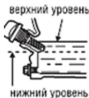
Снимите крышку с отверстия для масла и протрите измерительный щуп.
