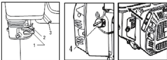
1. Поверните топливный кран (1) в положение ON (Вкл.). 2.Передвиньте рычаг дросселя (2) в положение CLOSE (закрыто).
