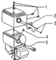
1. Снять оба 4-х мм винта [3] с отводного металлического листа выхлопной трубы [1] и снять лист.
