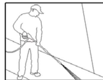
Рис. 6. Оптимальный угол относительно очищаемой поверхности
