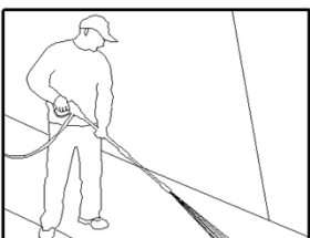
Рис. 6. Оптимальный угол относительно очищаемой поверхности
